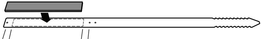
**3.** Assembler la visière à la bande contour de tête à l'aide des rivets
